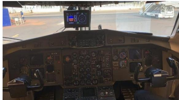
Figure 9: Poste de pilotage équipé pour le vol de démonstration d'un écran de navigation externe
