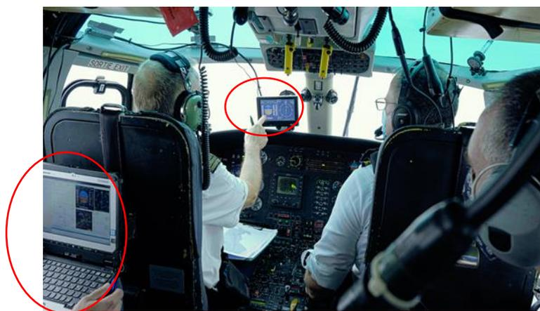
Figure 12: Poste de pilotage équipé pour le vol de démonstration d'un écran de navigation externe
